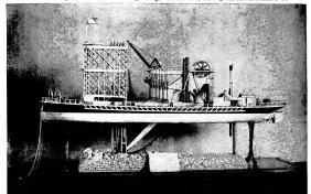
F16. 12.—MODEL OF ROCK-CUTTING DREDGER, "DEROCHEUSE."
